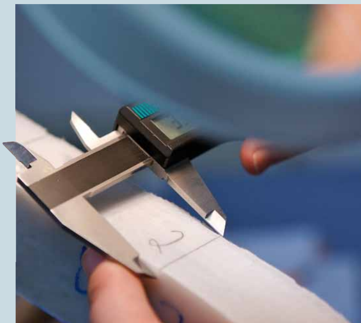
Mit Präzisionsschieblehre wird die Liner-Wanddicke gemessen
